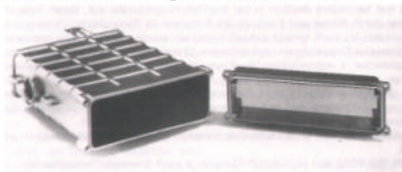
Polyamid 6, glasfaserverstärkt Automobilelektronik EMI-shielding durch galvanisch Mattnickel – manuelle Entnahme empfehlenswert – Werksfoto Keim GmbH
